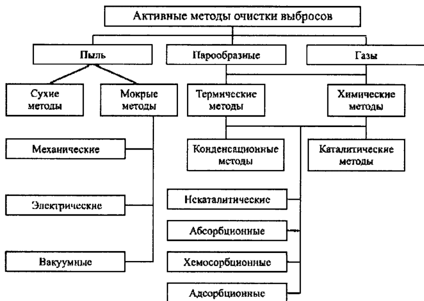
Рис. 9.2. Классификация методов очистки от стационарных выбросов ЗВ
